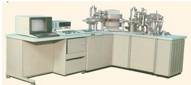
Мас-спектрометр МІ 1201 ІГ (ВО «Електрон», 1988 р.), у вакуумній системі якого були використані надвисоковакуумні орбітронні насоси, розроблені Лободою В.Б.
