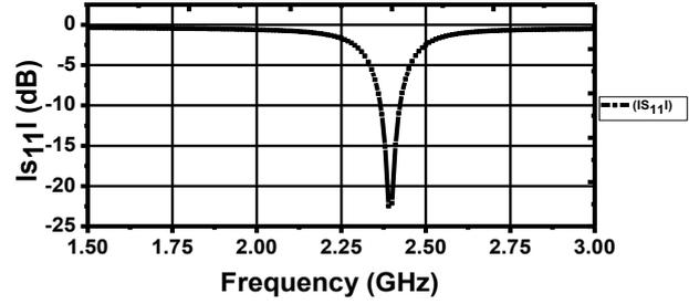
Fig. 2 – S-Parameter: Reflection coefficient
