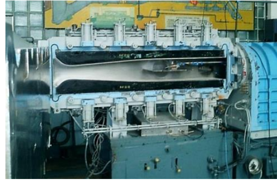
Рис. 2 – Робоча частина надзвукової аеродинамічної труби Т-325
