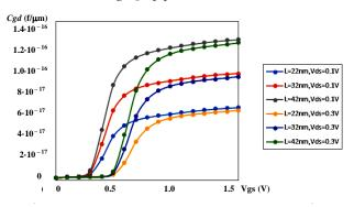
Fig. 5 – Gate-drain capacitance at  $L_{\rm g}=22$  nm, 32 nm, 42 nm with  $N_{\rm d}=10^{18}/{\rm cm^3}$
