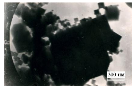
Рис. 4 - Структура металлических пленок контактов Ag/n-GaAs. t_{отж} = 823 К, t_{отж} = 10 минут
