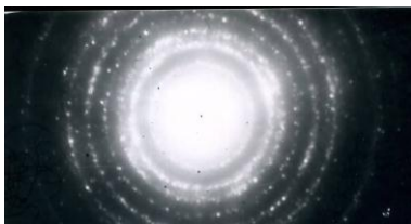
Рис.3 - Электронограмма от пленки барьерного перехода Ag/n-GaAs. t_{отж} = 823 К, t_{отж} = 10 минут
