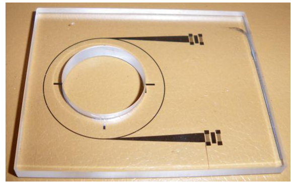
Рис. 12 – Експериментальний зразок кільцевого хвилевода поверхневих акустичних хвиль
