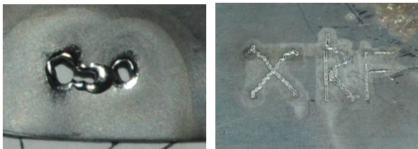
Рис. 6 – Результати руйнування мішені електронним пучком
