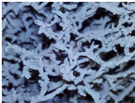
Рис. 1 – Зовнішній вигляд кобальтового порошку, отриманого після автогоріння
