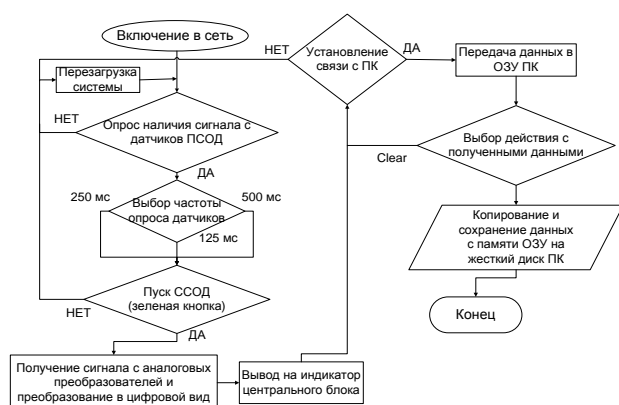
Рисунок 4 – Алгоритм работы микропроцессорной системы
