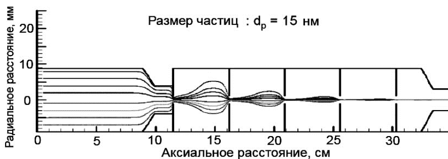
Рис. 13 – Траектории частиц с размером 15 нм в аэродинамической системе линз [97, 98]
