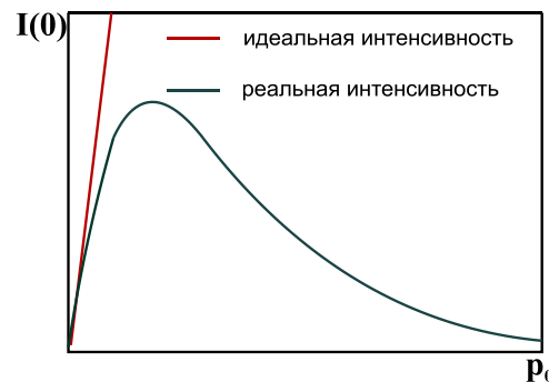
Рис. 8 – Зависимость интенсивности от давления в сопле
