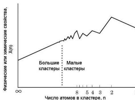
Рис. 2 – Изменение свойств кластеров в зависимости от числа, составляющих их атомов
